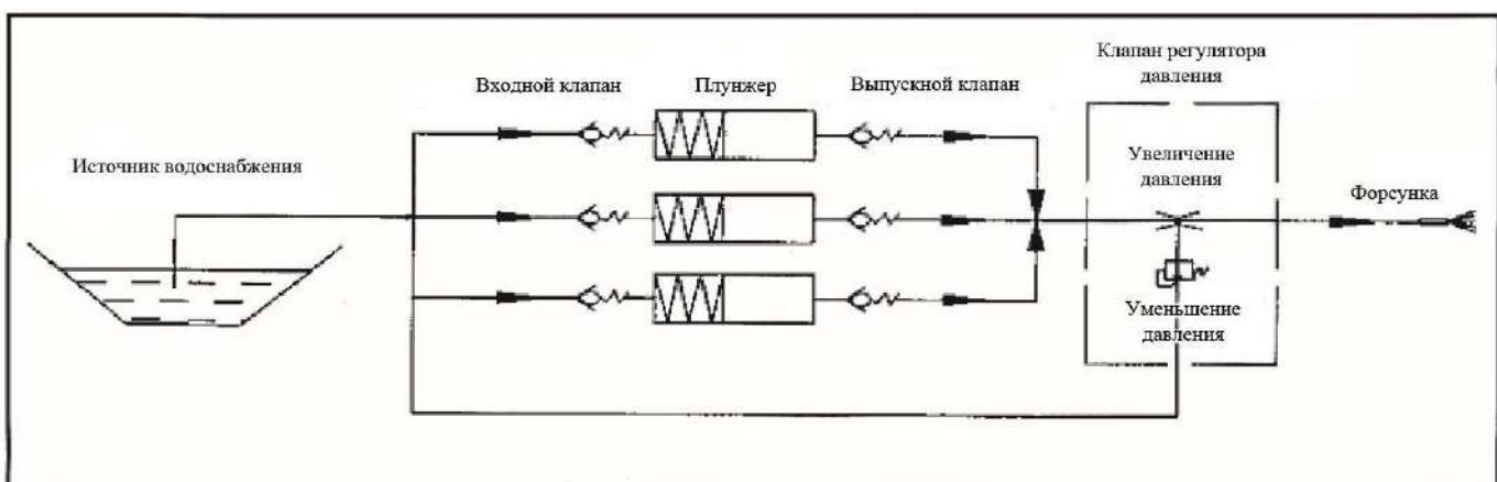
При включении в сеть вал помпы приводится в движение двигателем. Движение от вала передается плунжеру насоса, который совершает возвратно-поступательные движения. Когда объем камеры помпы увеличивается, входной клапан открывается, а выпускной закрывается, и вода поступает в камеру помпы по шлангу через входной клапан. Когда объем камеры помпы уменьшается,
